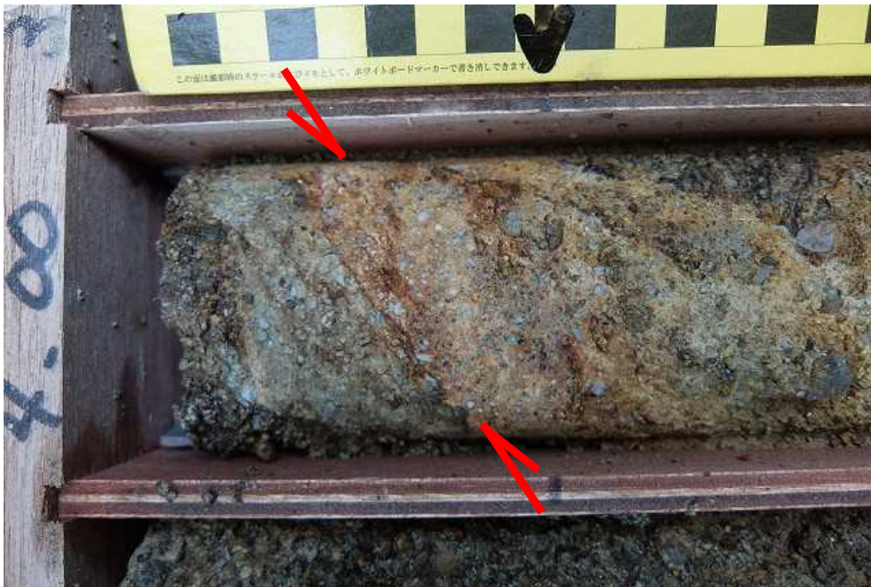
①GL-4.05mの粘土層 脆弱な粘土層で20～30° の面構造が認められる。
