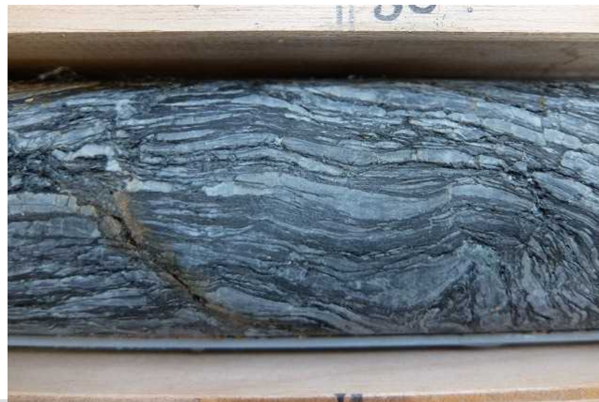
GL-9.5m付近 新鮮な泥質片岩
