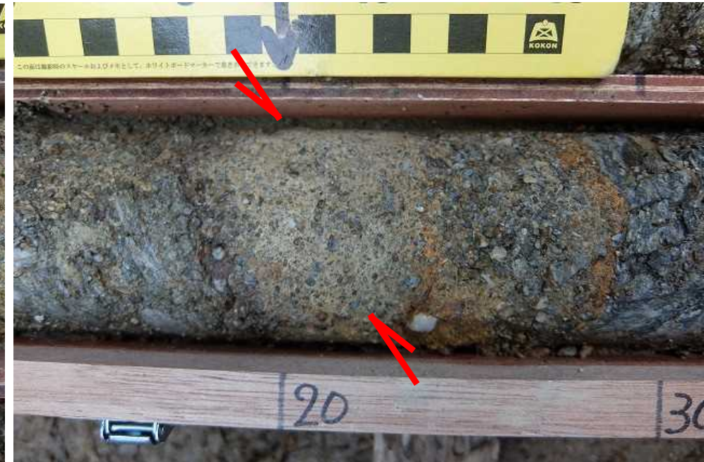
②GL-5.20～5.25m付近の粘土層 非常に脆弱な粘土層で、指圧で容易に変形する。約20° の面構造が認められる。
