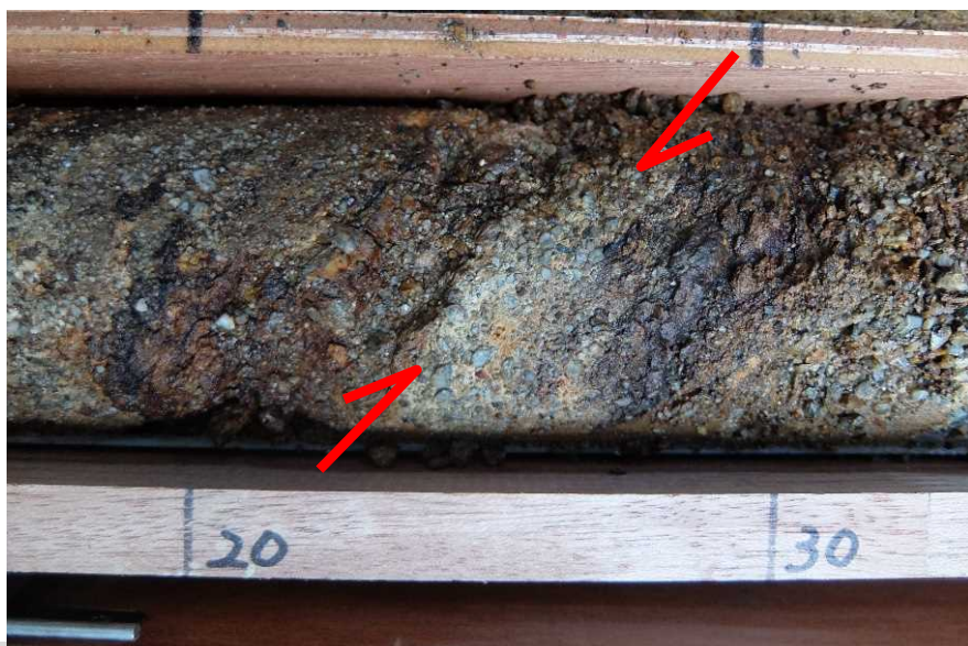
③GL-8.25m付近の粘土層 20° 程度の面構造が認められる。
